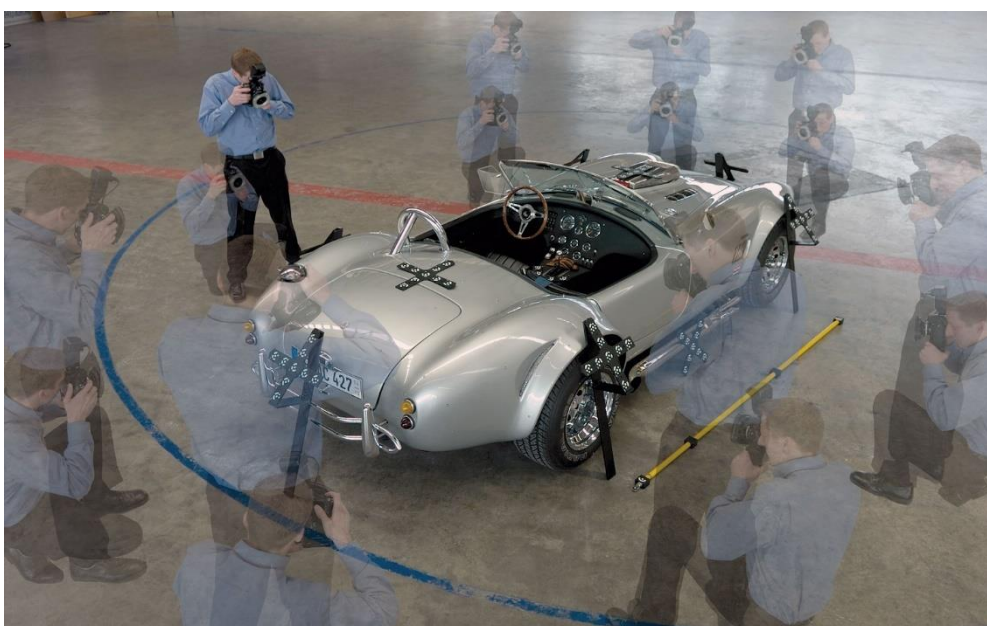
Рис. 4 – Съёмка автомобиля со специальными марками
